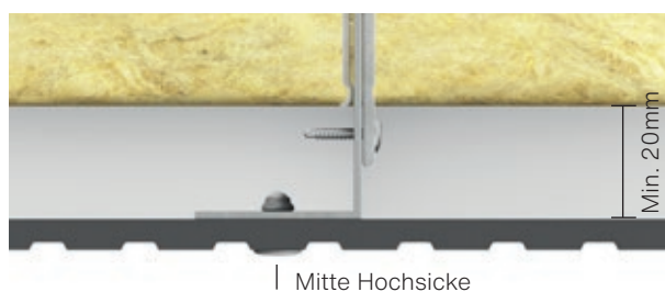
Abb. 2. Swisspearl Patina Inline - Befestigung auf L-Tragprofil
