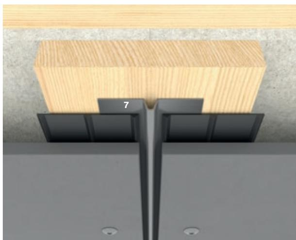
Swisspearl Fugenprofile können sowohl vertikal als auch horizontal verwendet werden. Swisspearl Fugenprofile sind nicht zwingend erforderlich, bieten aber eine ästhetische Optik und verhindern, dass Insekten in die Hinterlüftungsebene gelangen. Das Profil wird genauso montiert wie ein Swisspearl Außeneckenprofil. Es wird empfohlen je min. 4mm Fuge zwischen Profil- und Tafelkante vorzusehen.
