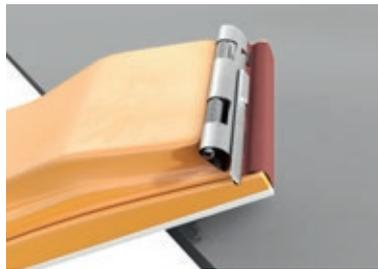
Nach dem Zuschnitt können die Kanten mit einem Schleifpapier gebrochen werden. Die Fase sollte einen 45° Winkel aufweisen. Das verleiht der Tafel Stabilität und kaschiert Ausbrüche.
