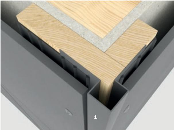
Swisspearl Außeneckenprofile werden für 90° Außenecken verwendet. Die Außenecken werden mit Schrauben in vorgebohrte Ø4 mm Löcher befestigt. Die Fassadentafeln halten die Außenecke in der richtigen Position, wobei das Profil sich frei ausdehnen kann.
