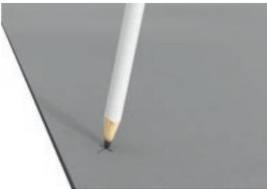
Stellen Sie bei der Markierung der Bohrlöcher oder Schnittkanten auf der Tafel sicher, dass diese kleiner sind als der Bohrer, bzw. schmaler als das Sägeblatt.
