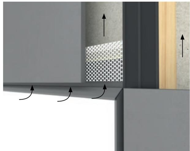
Ebenso muss eine Lüftungsöffnung über Fenstern und Türen eingehalten werden. Dieser Spalt muss mindestens 10 mm breit sein. Werden Lüftungsprofile verwendet, wird ein Belüftungsquerschnitt von mindestens 50 cm<sup>2</sup> pro Meter benötigt.
