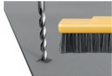
Staub vom Schneiden oder Bohren muss gleich entfernt werden, da sonst Spuren auf der Oberfläche zurück bleiben können.
