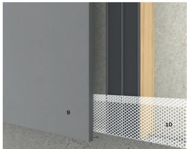
Swisspearl Abtropfkante leitet Wasser von der Fassade zu einer vorspringenden Kante, von der das Wasser abtropfen kann. Das Profil kann in Verbindung mit dem Lüftungsgitter eingesetzt werden um zu verhindern, das Nager und Kleintiere in den Hohlraum hinter den Fassadentafeln gelangen. Die Fuge zwischen der Fassadentafel und dem Profil soll mindestens 4mm betragen.
