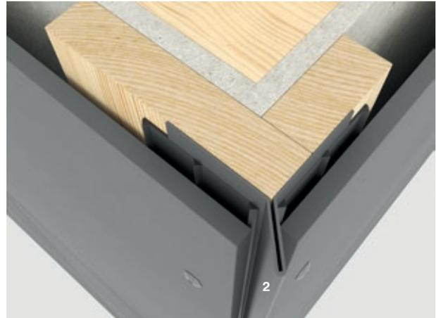
Swisspearl Y-Außeneckprofil kann ebenso für 90° Außenecken verwendet werden. Es wird wie das Außeneckenprofil mit Schrauben montiert. Der Abstand von der Innenkante der Fassadentafeln zum Profil sollte mindestens 2mm betragen.
