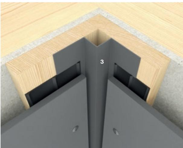
Swisspearl Inneneckprofil wird für 90° Innenecken verwendet. Die Inneneckprofile werden mit Schrauben in vorgebohrte Ø 4mm Löcher befestigt. Die Fassadentafeln halten die Innenecke in der richtigen Position, wobei das Profil sich frei ausdehnen kann. Es sollte ein Mindestabstand von 4mm zwischen den Tafelkanten und dem Profil, bestehen.
