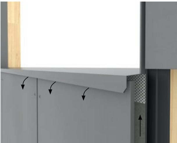
Unter den Fensterbänken ist ebenso ein Mindestabstand von 10 mm oder 50 cm<sup>2</sup> pro Meter einzuhalten. Der Lüftungsspalt wird zwischen der oberen Kante der Fassadentafel und der Unterkante der Fensterbank gebildet. Es wird empfohlen, die Tropfkante/Wassernase mindestens 30 mm vor die Fassadenfläche zu setzen. Dieser Aufbau stellt sicher, dass abfließendes Wasser vom Fenster nicht in die Unterkonstruktion/hinter die Fassadentafeln läuft.
